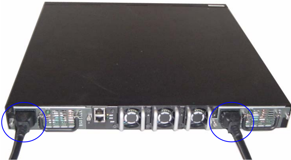
Ilustración 2. Conexión de los cables de alimentación
